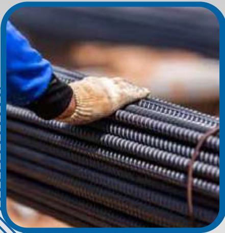
La barilla corrugada se utiliza comúnmente en proyectos de estructuras de hormigón armado, como cimientos, columnas, vigas y losas, ya que ayuda a reforzar y fortalecer la estructura al proporcionar una mejor unión entre el acero y el concreto. Estas estrías le confieren a la barra una mayor adherencia con el concreto en aplicaciones de construcción.
